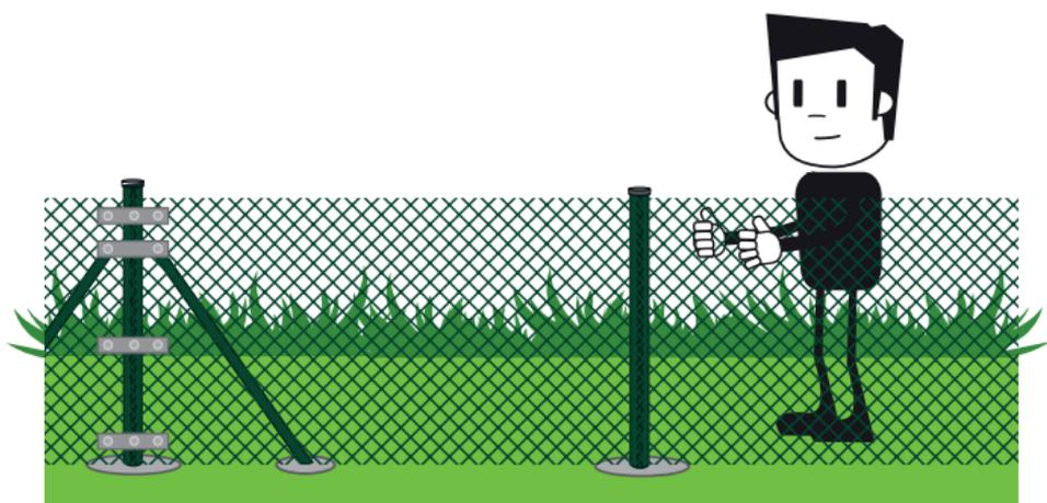
6. Pasar las 3 hiladas de alambre entre la malla de un poste tensión a otro y tensarlas, comenzando por la hilera inferior
