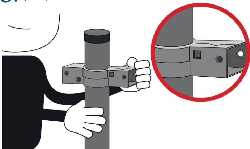
4. Colocar el bastidor, asegurándonos de encajarlo dentro de las abrazaderas
