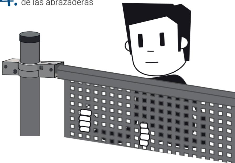
5. Cimentar el siguiente poste y encajar el panel en las abrazaderas. Atornillar las 4 abrazaderas al bastidor.
