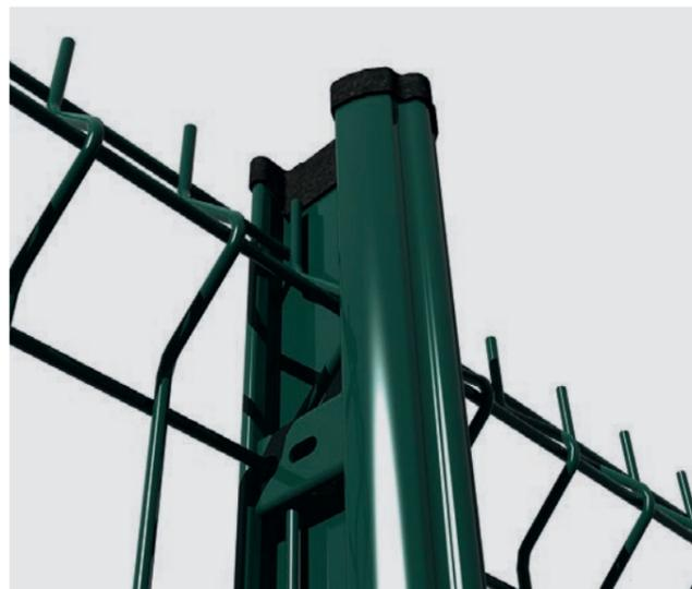
Fabricado a partir de chapa galvanizada Z-275 perfilado en frío, con entallas equidistantes que permiten fijar los paneles al poste sin ningún accesorio ni soporte, los bastidores Ritmo o Ritmo DH una vez instalados no se pueden desmontar y el sistema es inviolable. Posibilidad de realizar ángulos de 90° con un solo poste.
